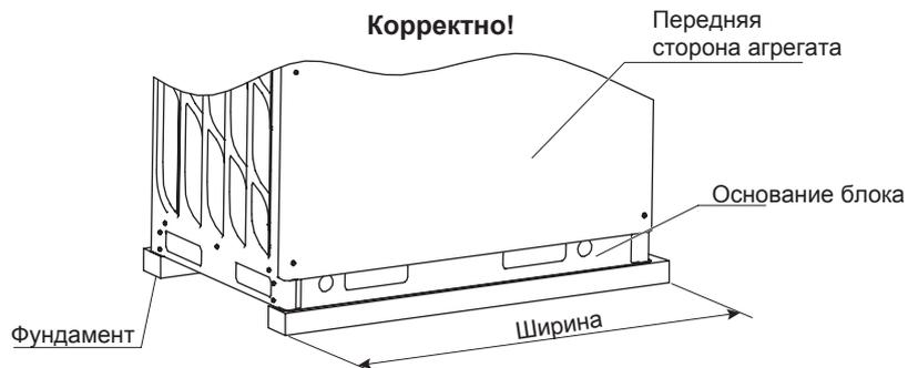
\* Не допускайте размещения агрегата на фундаменте, пример которого показан на иллюстрации ниже. В противном случае, возможно повреждение основания блока.
